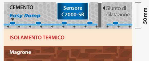
**Isolamento termico consigliato:** Polistirene estruso (conduttività termica  $0,027 \div 0,036 \text{ W/m}^\circ\text{C}$  - resistenza meccanica  $200 \div 700 \text{ kN/m}^2$  - basso assorbimento d'acqua  $0,04 \div 0,10\%$ )
